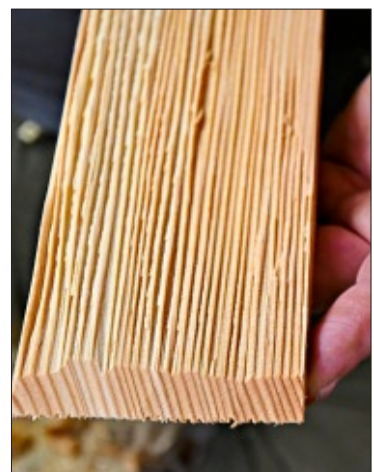
Von Hand gespalten und gefast, so sieht eine Qualitätsschindel aus der Werkstatt von Josef Pfeffer aus. – Foto: Sven Bauer
